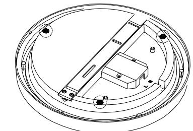
**Attention : Veuillez noter que le couvercle du plafonnier doit être totalement sécurisé pour atteindre l'indice d'étanchéité prévu (IP)**
