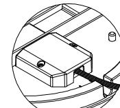
Veuillez s'il vous plaît ne pas forcer la fermeture du couvercle ou tirer les câbles au risque de perdre la protection IP.
