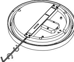
Pour fermer tourner dans le sens des aiguilles d'une montre et dans le sens contraire pour ouvrir
